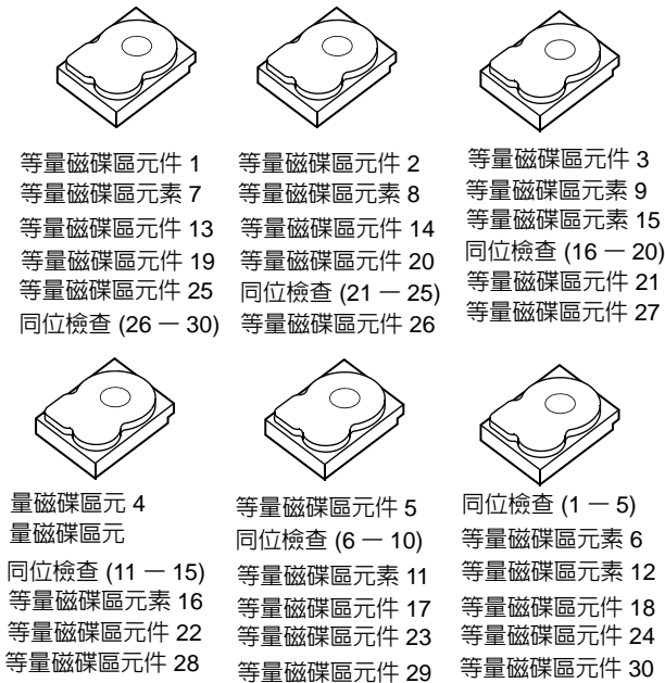
圖 2-3. 分散式同位檢查的範例 (RAID 5)
